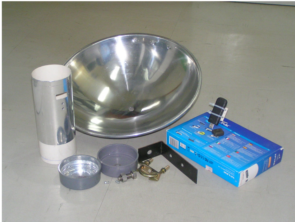
Gambar Bahan Untuk Membuat Antene Wajan Bolic
