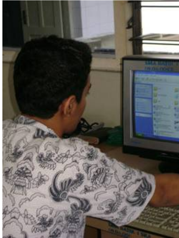
Gambar Siswa sedang mengatur setting koneksi client I dengan Access Point (AP), hal ini dilakukan agar Clieen I dapat memperoleh sinyal yang dipancarkan oleh Access Point tersebut.
