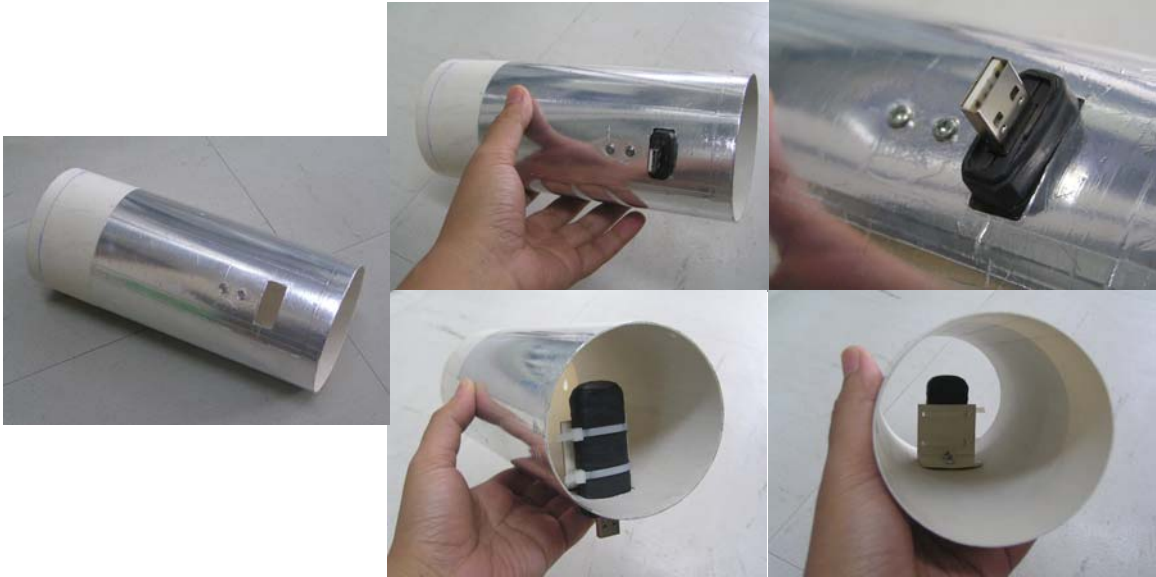
Pemasangan USB Wirelees Pada Pralon yang telah dibalut Alumunium Voil
