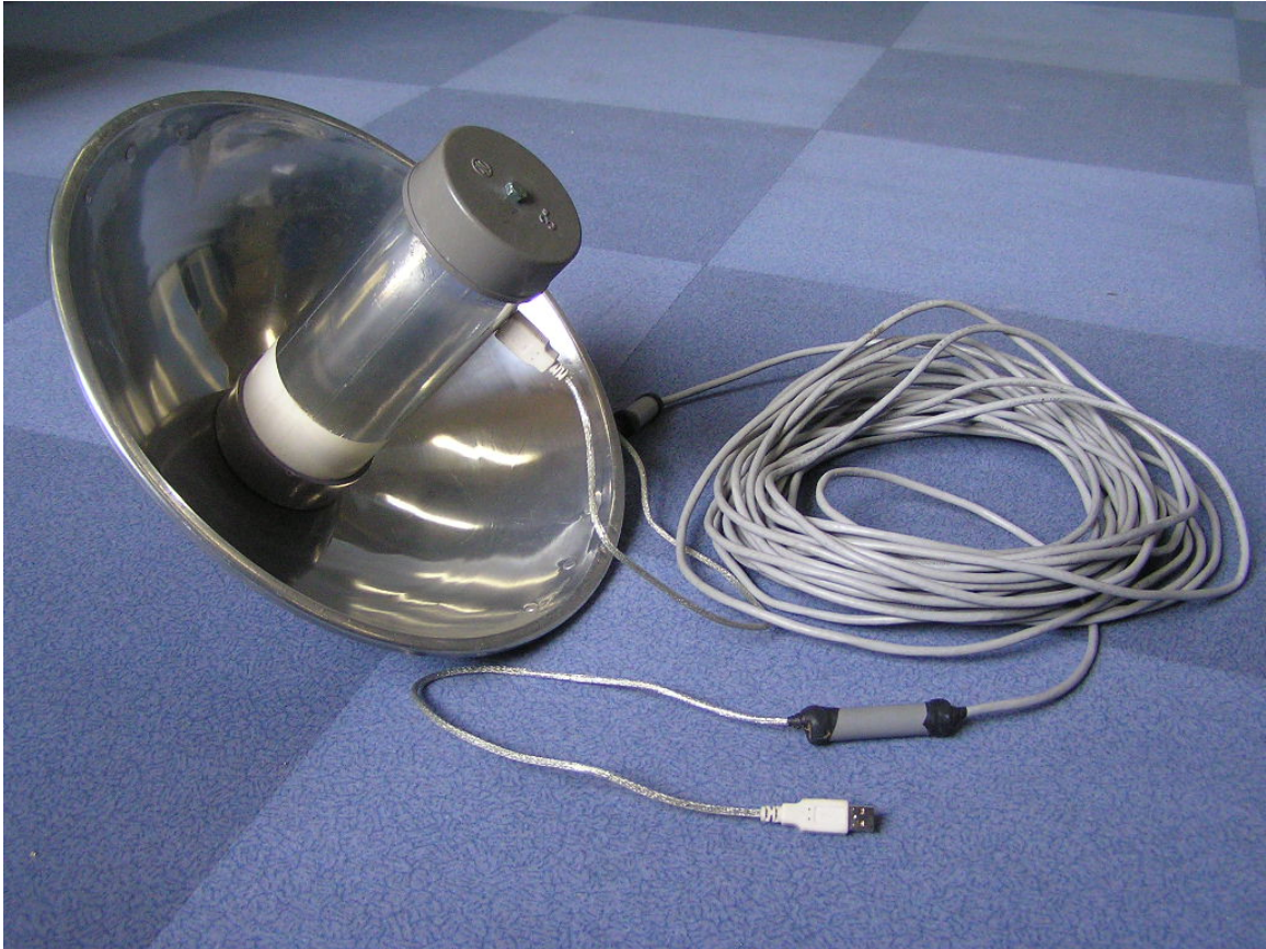
Gambar Antena Wajan Bolic dan Kabel USB yang Siap Untuk digunakan
